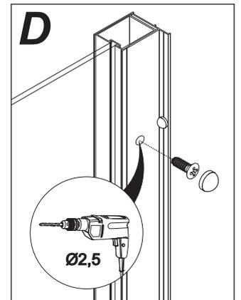
Ajuster le joint magnétique si faux aplomb du mur
