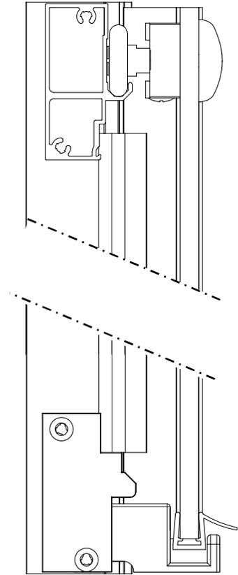
Engager la porte dans le guide en même temps que les roulettes dans le rail
