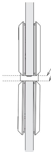
Les charnières doivent être alignées sur le bord des vitrages.
